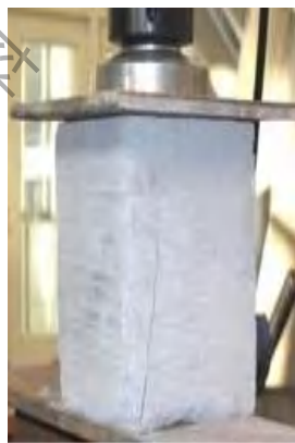
混凝土受压破坏
