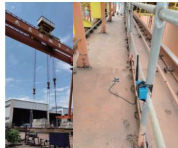
桥式起重机型式试验应力测试
