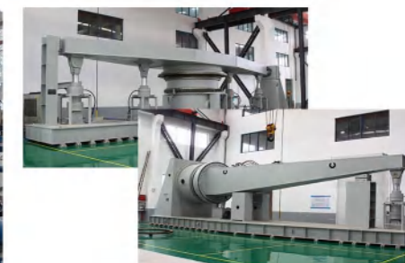
风电回转支承性能试验台 最大工件规格：Φ6500mm
