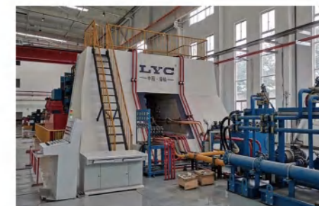
盾构机主轴轴承试验台 最大工件规格：Φ4800mm
