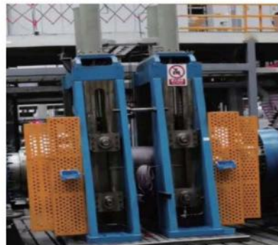
2016年 8MW齿轮箱试验台 刚性轴/低速轴连接器
