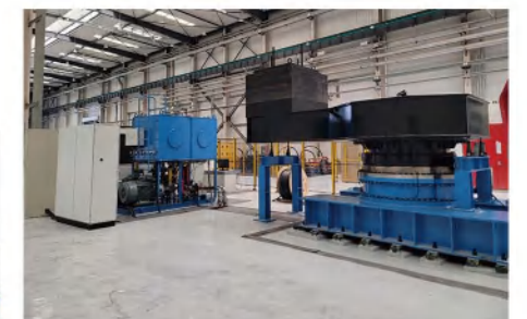
工程机械回转支承试验台 最大工件规格：Φ1600mm
