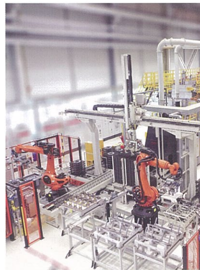
▲ 机器人上卸料，可实现生产线无人化作业
