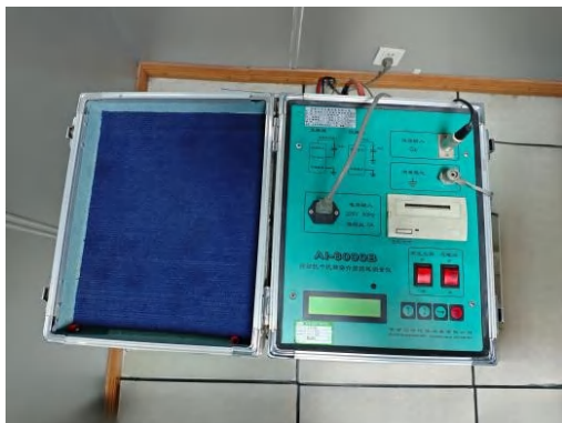
介质损耗测试仪
