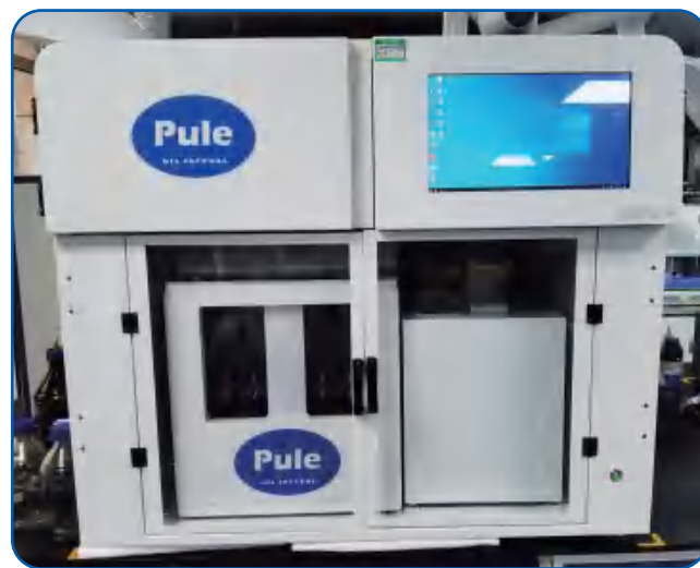
全自动进样折管粘度计 自动进样, 四路同时测试
