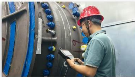
车间螺栓质量管理及工艺验证
