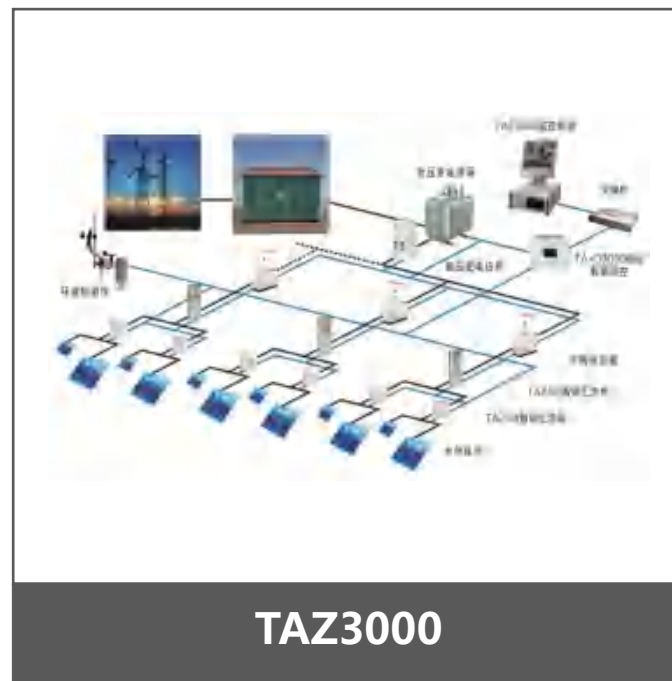
新能源智能变配电监控系统
