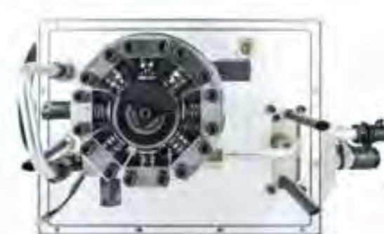
8柱塞副三级流量结构，极佳压力/流量曲线
