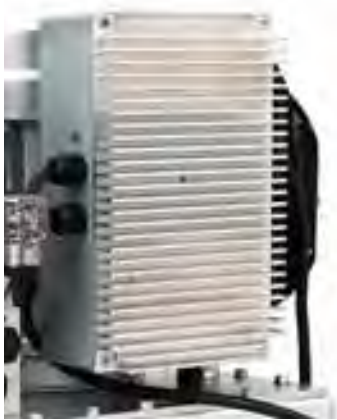
带翅片散热铝合金电控箱，内置电路板控制
