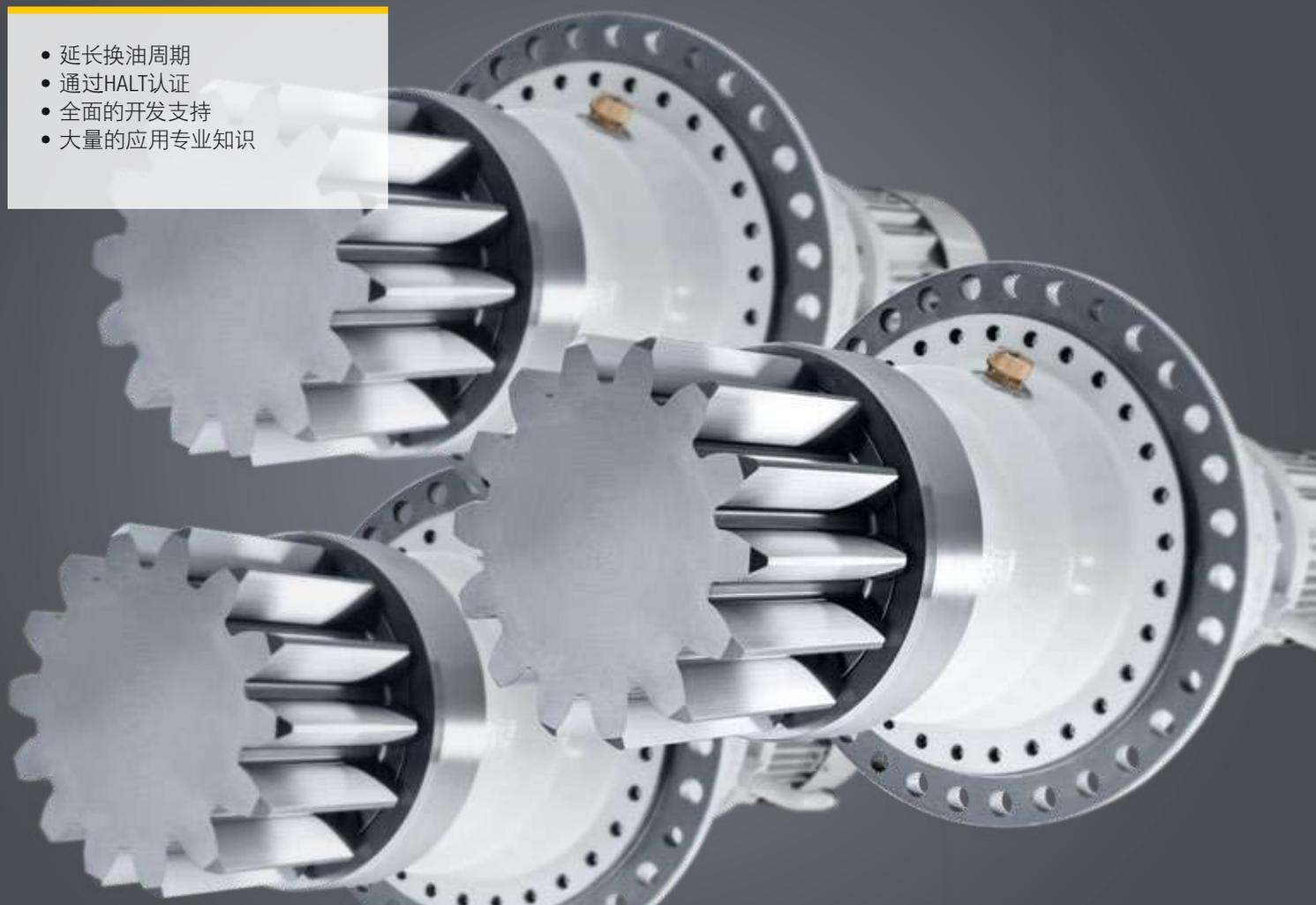
可靠性和精确定位是风轮叶片和偏航调节驱动的关键因素。利勃海尔提供多级行星减速箱，用于风轮叶片调节。如果安装条件有限，也可以选配直角行星减速箱。三、四级行星减速箱通常用于偏航调节。每个偏航系统可以安装12个或以上的偏航驱动，用于传输高兆瓦级风机的高扭矩。
