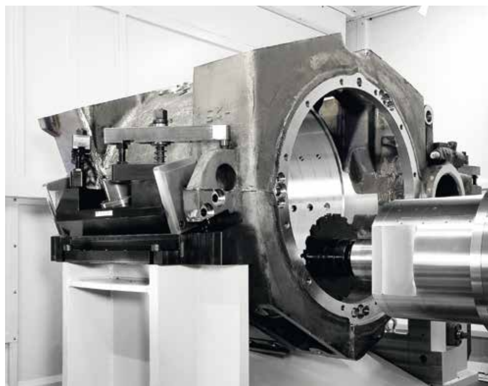
— 无级调整的数控镗杆，行程 500 mm 或 760 mm
