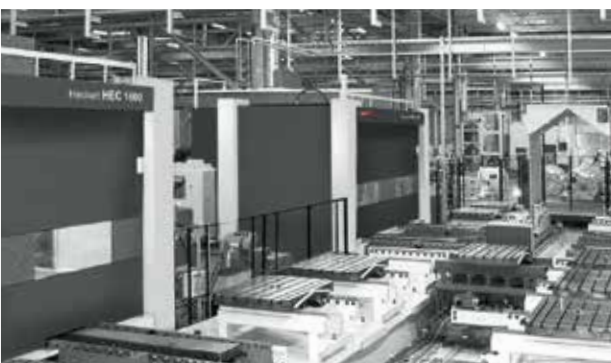
— 用于加工风电大齿轮的柔性制造系统
