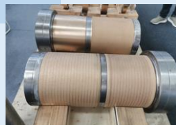
滑动轴承外表面铜合金涂层
