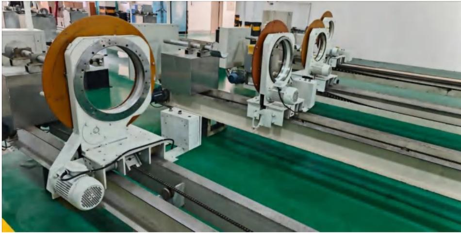
机械绕包式母线生产设备
